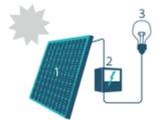
1. Zonnepaneel | 2. Omvormer | 3. Elektrische toestellen
