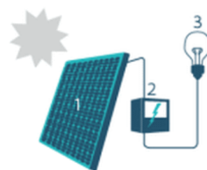
1. Zonnepaneel | 2. Omvormer | 3. Elektrische toestellen
