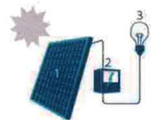
1. Zonnepaneel | 2. Omvormer | 3. Elektrische toestellen
